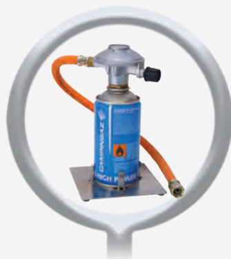
Sicherheitsadapter CG 1750 mit integriertem Druckminderer, DVGW- Schlauch (0,5 m) und Edelstahlhalter für Kartuschen mit 7/16" x 28 UNEF-Gewinde, z.B. CG 1750 Art.-Nr. 6.000.810
